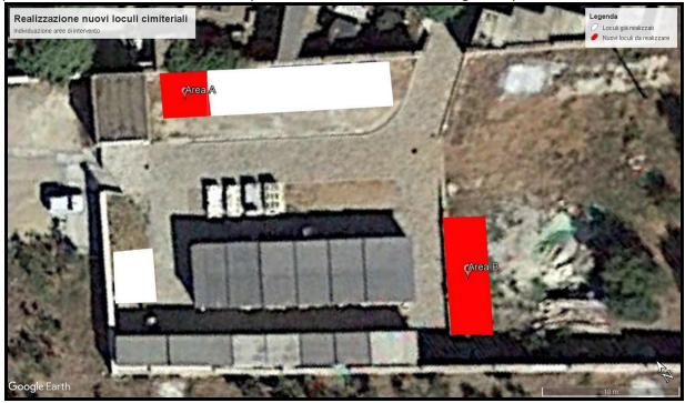
**L'area A**, così come individuata nella planimetria, è collocata in aderenza al muro perimetrale del vecchio cimitero a completamento del comparto già realizzato nel corso dell'anno 2020, ed avrà un ingombro di circa 5,00 x 2,50 metri. Sarà in grado di ospitare complessivamente 15 loculi disposti su 5 colonne composte da 3 loculi ciascuna. Nel dettaglio verranno realizzati esclusivamente loculi ad imboccatura frontale.
